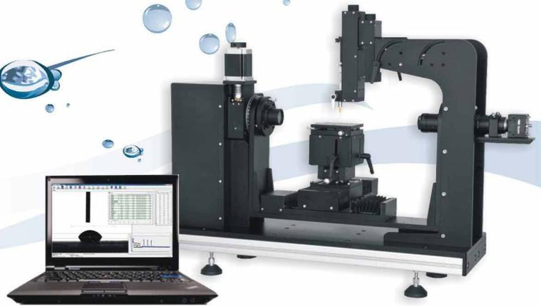
C60系列影像分析系统是基于光学影像法原理测试界面化学性质的专业系统。通过分析各种基于液-气、液-液或液-固、液-液-固等两相或三相界面化学体系形成的液体（Drop）或气泡（Bubble）的外形轮廓（Drop shape / Lamella Contour Profile），可以用于分析诸如表面张力及其分量（色散力、极性力）、界面张力、固体表面自由能及其分量（色散力、极性力、氢键力、Lewis酸碱力等）、界面流变(Interfacial Rheology)及粘弹指数（Interfacial Viscosity）、粘附功、润湿线、润湿行为（Wetting Behavior）等重要界面化学指标，用于表征、分析、推测或描述如铺展、润湿、粘附、吸收、竞争、渗透、增溶以及表面各相异性等各种重要的界面化学属性，可全面被各类新材料研究（仿生超疏水或超亲水材料）的学术研究人员、液体界面化学研究的科研人员、质量控制QC（如表面清洁度分析）和产品开发等生产制造的专业工程师所使用。
